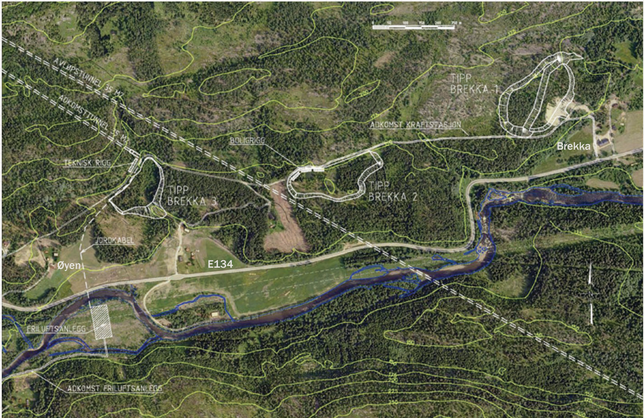
Tre av dei seks planlagde tippane vil verta etablert mellom Brekka og Øyen. Tippene vil verta godt skjerma frå busetnad og E134. Kraftleidningen vil verta lagt som jordkabel frå adkomsttunnelen og ned til friluftsanlegget/koplingsanlegget ved eksisterande 132 kV leiing. Sjølve Sauland kraftverk vert liggande om lag 1 km inne i fjellet.
